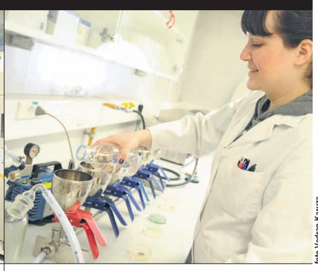
Aleksandra Jurić, pri uređaju za membransku filtraciju na kojem se provodi izolacija mikroorganizama iz uzorka vode
